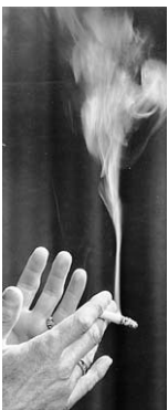
Laminaire en turbulente stroming in de rookpluim van een sigaret.
